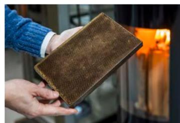
Neuartiger Filter zur Emissionsreduzierung bei Öfen
