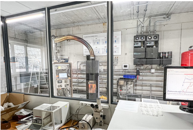
Im Tiba-Labor werden Emissionswerte, Effizienz, Oberflächentemperatur und die Sicherheit der Produkte gemessen.
